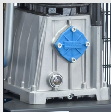
Olejoznak pro snadný odečet stavu oleje
