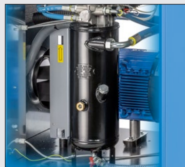
Vertikální vysoce účinná třístupňová separace oleje
