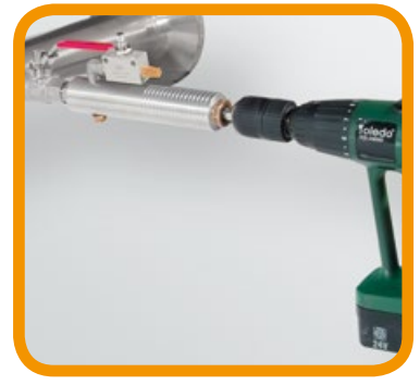
Vrtání pod tlakem pomocí speciálního nástavce
