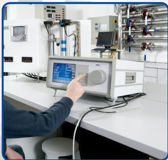
Kalibrační rozsah: od -80 do +20 °Ctd Přesnost reference DKD: 0,1 °Ctd
